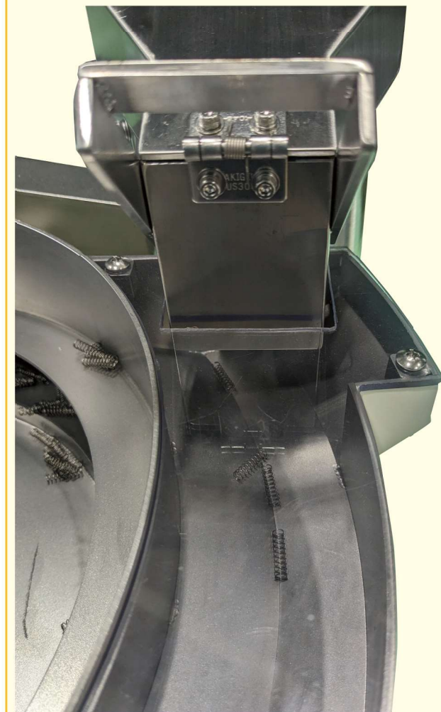
バネほぐし機からボウルフィーダへの排出部
